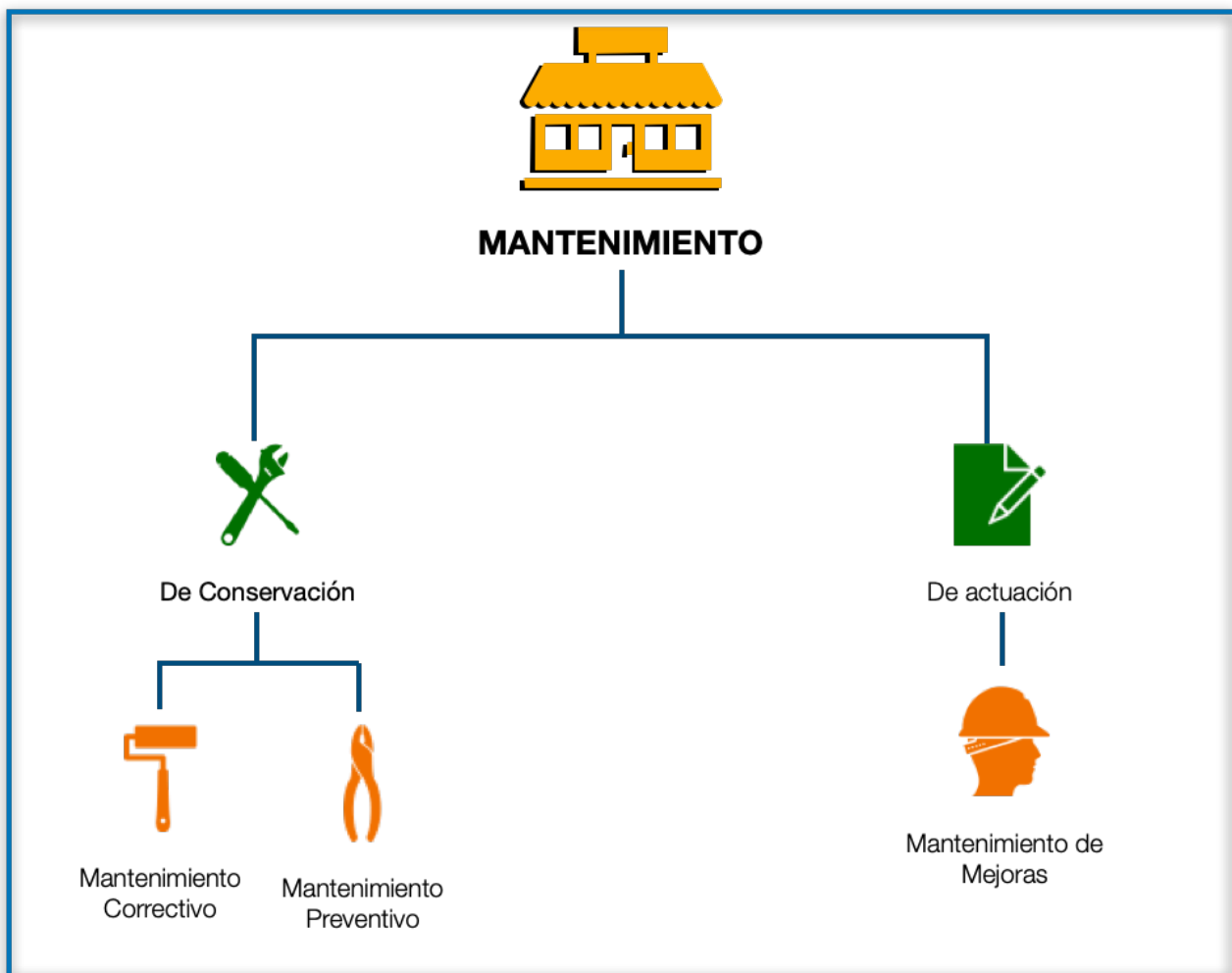
Esquema de Mantenimiento de edificios
